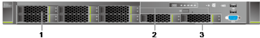
Рис. 4-2 Передняя панель сервера с восемью 2,5-дюймовыми жесткими дисками
