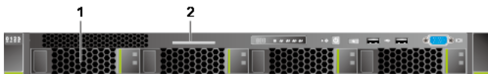
Рис. 4-1 Передняя панель сервера с четырьмя 3,5-дюймовыми жесткими дисками
