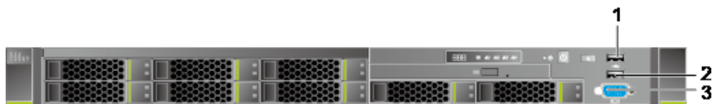
Рис. 4-6 Передняя панель сервера с восемью 2,5-дюймовыми жесткими дисками
