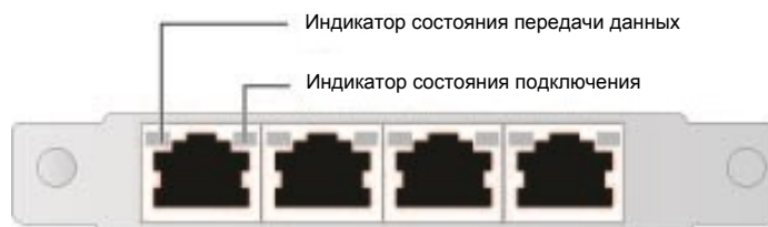
Рис. 4-12 SM210 с четырьмя электрическими портами GE
