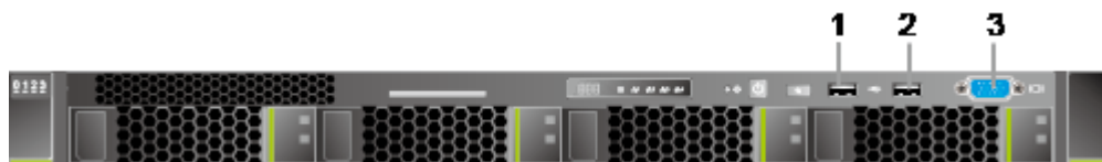
Рис. 4-5 Передняя панель сервера с четырьмя 3,5-дюймовыми жесткими дисками
