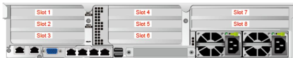
Модуль ввода-вывода 1 предоставляет слоты 1–3, модуль ввода-вывода 2 предоставляет слоты 4–6, и модуль ввода-вывода 3 предоставляет слоты 7 и 8.
